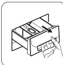
Потяните дозатор моющих средств на себя до упора. Положение **A** перегородки для моющих средств предназначено для порошкового моющего средства.
